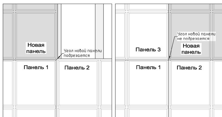
Рисунок 22. Перекрытие четырёх панелей в месте пересечения: Этапы 1 - 2.
